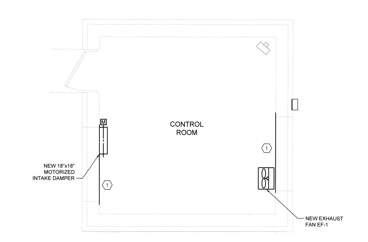
PUMP STATION MECHANICAL PLAN - NEW PLAN
