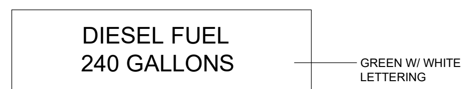
SIGN DIMENSIONS: 30" WIDE X 12" HIGH FUEL TANK - SIGN #3 8 SCALE: N.T.S. S-7
